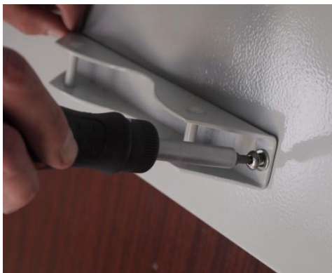
Figura 3 – Atornillando el Soporte Estándar al radar
